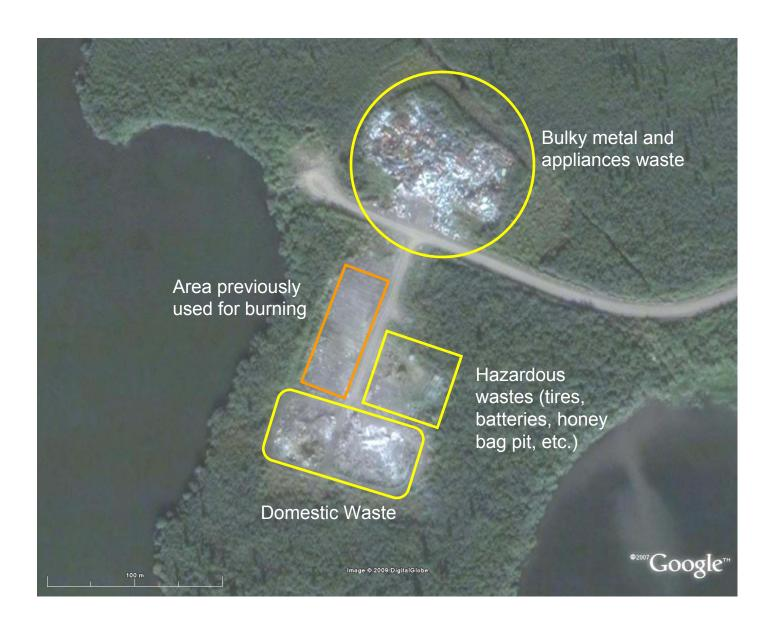
Figure 4. Landfill Site Plan
